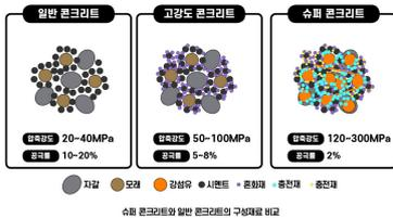
슈퍼 콘크리트는 강도가 일반 콘크리트 대비 5배 이상(압축강도 80~180MPa), 내구수명이 200년 이상으로 일반 콘크리트 대비 4배 이상입니다. 게다가 물치럼 현상은 특성이 없습니다. 그래서 수명 200년에 기준에 불가능했던 곡선이나 복잡한 구조의 건축물을 지을 수 있습니다.
