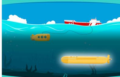
보통의 무인잠수정은 케이블이 연결돼 그 케이블을 통해 전원을 공급받고 통신을 합니다. 때문에 케이블 작동 범위까지만 구동이 가능한 한계가 있지요. 그래서 선박해양플랜트연구소는 케이블 없이 스스로 움직이는 자율 무인잠수정(AUV, Autonomous Under Vehicle)도 함께 개발하려고 했습니다.
