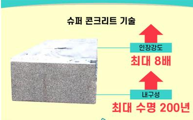
한국건설연구원은 압축강도 200MPa를 목표로 슈퍼브리지200 연구개발을 본격적으로 시도했습니다. 그 결과, 저비용 장수명의 콘크리트 사장교 기술을 개발하는데 성공했지요. 사장교 건설 시 공사비 20% 절감, 수명 2배 이상으로 200년까지 보장하는 기술입니다.
