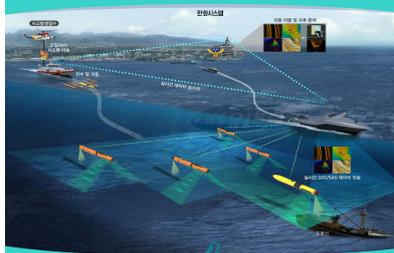
선박해양플랜트연구소는 센서를 활용한 항법시스템을 개발했습니다. 초음파센서와 관성센서를 이용해 AUV가 물속에서 자유롭게 다닐 수 있게 한 거지요. 맑은 강만하더라도 쉬운 일이 아니에요. AUV가 이동이 쉽게 하려면 작은 크기의 자전력 고정밀 센서가 필요하기 때문이지요.
